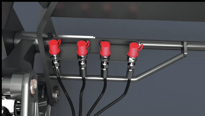
3. UN 4. HIDRAULISKAIS IZVADS. (šeit kā spraudsavienojums) Hidrauliskā aprīkojuma, kā skābbarības satvērējdakšas, ķīpu satvērējs vai ķīpu krautņotājs, vienkāršai lietošanai.
